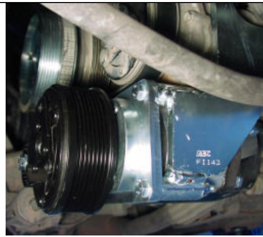
I – Eliminare la vite F . al suo posto montare la staffa 3 e fissare con viti fornite
